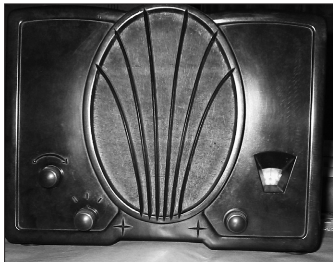
Philips 964 AS Philetta, zvaný Motýleček. Vyrobil Philips Praha v sezóně 1933/34. Lidový třílampový přijímač k napájení střídavým proudem. Foto: J. Jonášek
