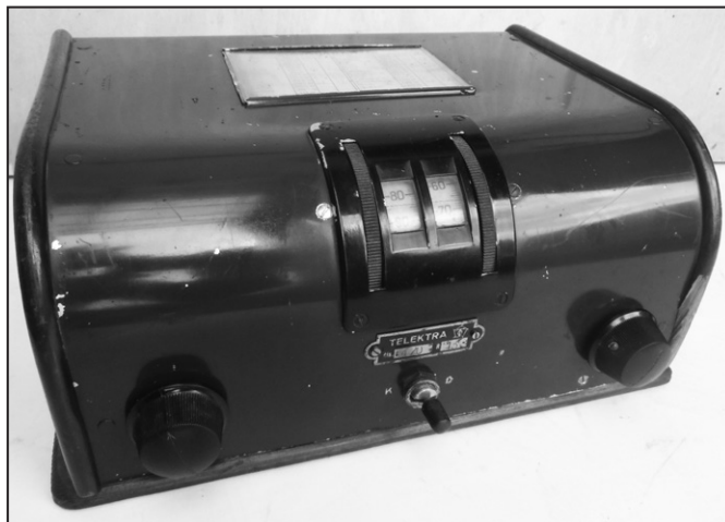
Třilampový přijímač Telektra R 13 Trion. Provoz na baterie. Vyrobita Telektra Olomouc 1928. U tehdejších rádií bylo nutno použít externí reproduktor. Foto: J. Jonášek
